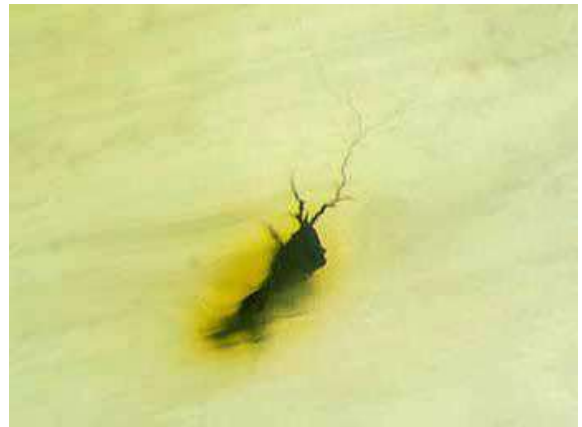
Рис.1.3 Трїїнг, що зародився на чужорідному включенні в ізоляції
