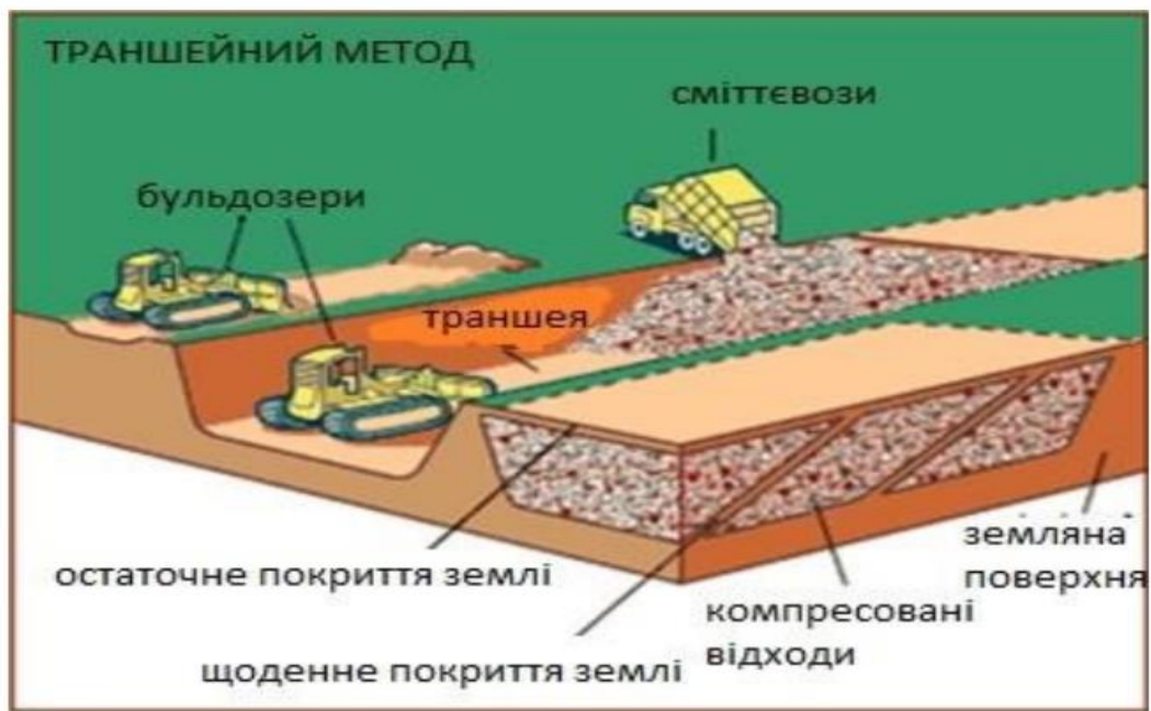
Рисунок 1.3. Траншейний спосіб захоронення відходів
