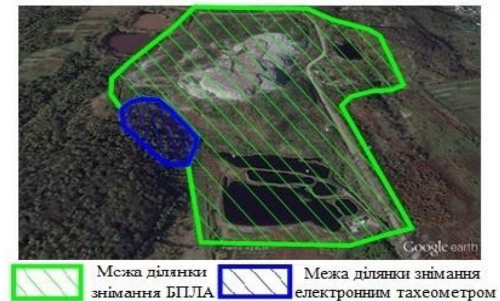
Рисунок 2.5. Ділянки меж використання дистанційних та контактних методів знімання на знімку Google Earth
