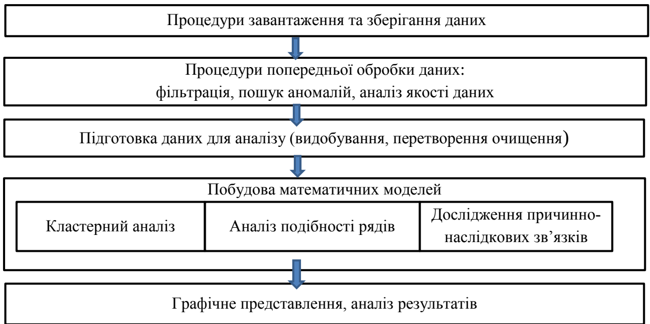
Рисунок 5.4 – Схема багатомодельного підходу із використанням теорії подібності процесів та ймовірісно-статистичного моделювання
