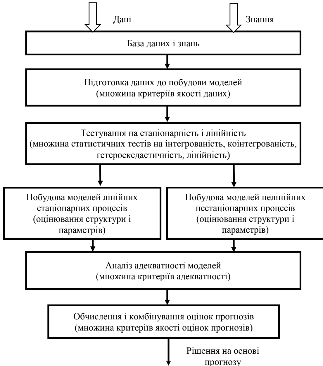
Рисунок 1.1 – Загальна схема аналізу нелінійних нестационарних процесів, побудови моделей та оцінювання прогнозів
