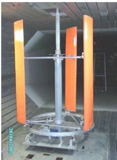
Рисунок 6.55 – Динамічна система, ротор Дар'є з керованими крилами.
