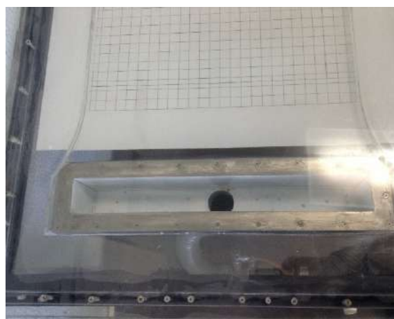
Рисунок 5.16 – Вигляд зібраної системи зливу рідини (фото)
