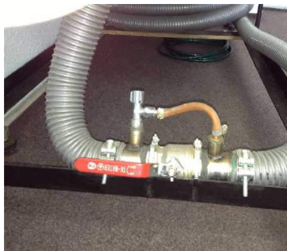
Рисунок 5.18 – Конструкція механізму керування швидкістю зливу рідини.
