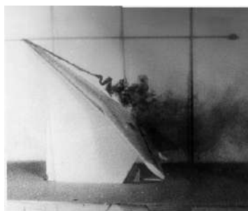
Рисунок 6.66 б)– Утворення тривимірних вихрових систем – вихрових жгутів.
