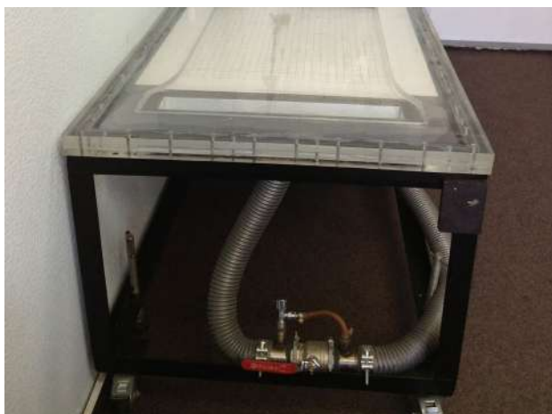
Рисунок 5.17 – Механізм керування швидкістю у системі зливу (розташування на стенді)
