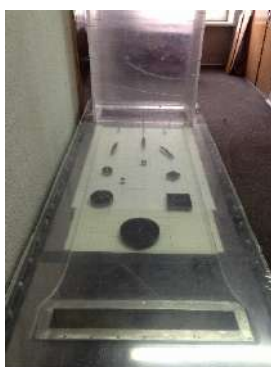
Рисунок 5.19 – Встановлення моделей в робочу частину стенду
